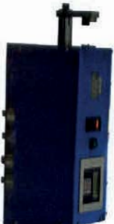
دستگاه سنجش خواص مکانیکی جهت ملنت کردن نمونه های کوچک به منظور متالوگرافی راحت تر
